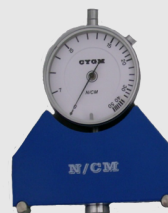
Tensiómetro para conocer la tensión de la pantalla
